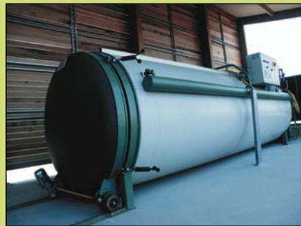
La cámara de secado de vacío (proceso discontinuo) dispone de una capacidad equivalente a 4 m<sup>3</sup> sólidos de madera.
