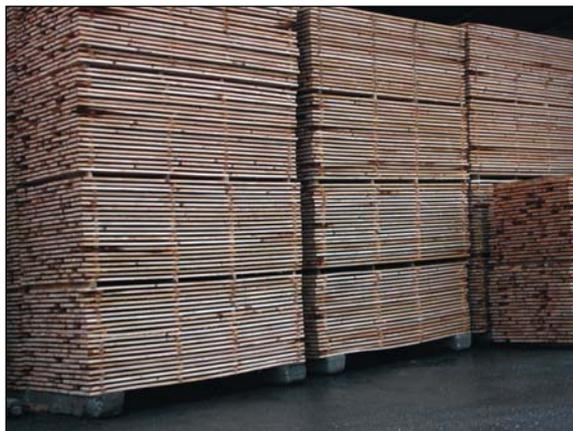
El mismo procedimiento se puede aplicar en el caso de secar madera con distintos espesores. En este caso, se recomienda alinear las columnas en profundidad por espesores, permitiendo una correcta distribución del aire al coincidir el hueco de los rastreles. Otra posibilidad, consiste en colocar las partidas de distinto espesor a distintas alturas, garantizando la uniformidad de la distribución del aire.
