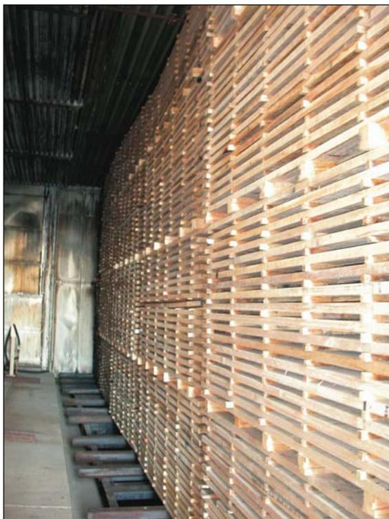
Para cada espesor de la madera se recomienda un espesor de rastrel. A mayor espesor de la madera mayor espesor del rastrel y mayor separación entre éstos. En la separación entre rastreles es necesario tener en cuenta la propensión de la especie de madera a presentar deformaciones, de modo que, a mayor riesgo de deformación mayor número de rastreles deben colocarse independientemente del espesor.
