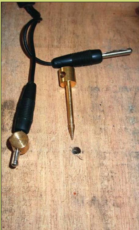
La fiabilidad de los datos obtenidos por este método es muy alta para intervalos de humedad comprendidos entre el 7 y el 30%. Con contenidos de humedad superiores los datos deben considerarse como una referencia mucho menos fiable.
