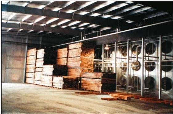
La continua manipulación de las partidas de madera puede provocar golpes y fisuras en las chapas, que deben ser reparadas y selladas para evitar que la humedad penetre en el aislamiento y lo degrade. De igual modo, se deben reparar las fisuras y mantener la planitud de la solera aplicando nuevos tratamientos aislantes cuando se precise.
