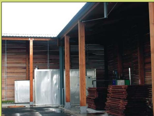
La cámara de secado convencional dispone de una capacidad máxima de 5 m<sup>3</sup> sólidos de madera (longitud máxima: 2,5 m). La instalación cuenta con una tina de vaporización alimentada por una caldera de vapor.
