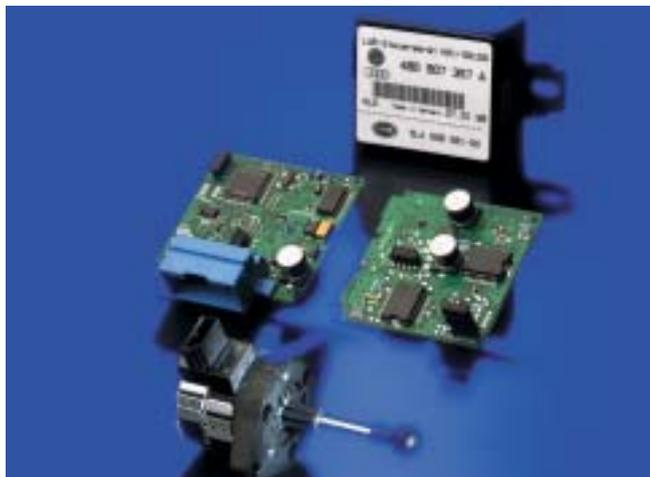
Unidad de control para una regulación dinámica del alcance luminoso
