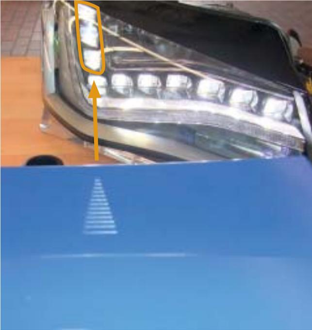
¡Para preparar el vehículo, es imprescindible tener en cuenta las indicaciones del fabricante! En la luz de cruce del Audi A8 se puede ver claramente. Como ya se ha mencionado acerca del campo delantero, los tres LEDs dispuestos en vertical generan tanto una parte simétrica de la luz de cruce como también una asimétrica (v. imagen).
