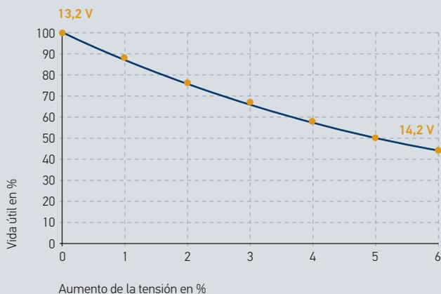
Por este motivo, en algunos tipos de vehículos se utilizaban resistencias en serie para que la tensión del suministro no superara los 13,2 V. En los vehículos modernos de hoy en día se ajusta la tensión por medio de una señal digital de modulación por impulsos. En caso de una subtensión, debido p. ej. a un fallo en el alternador, ocurre justo lo contrario. La luz posee entonces una proporción de rojo sensiblemente mayor y el rendimiento luminoso es, por tanto, menor.
