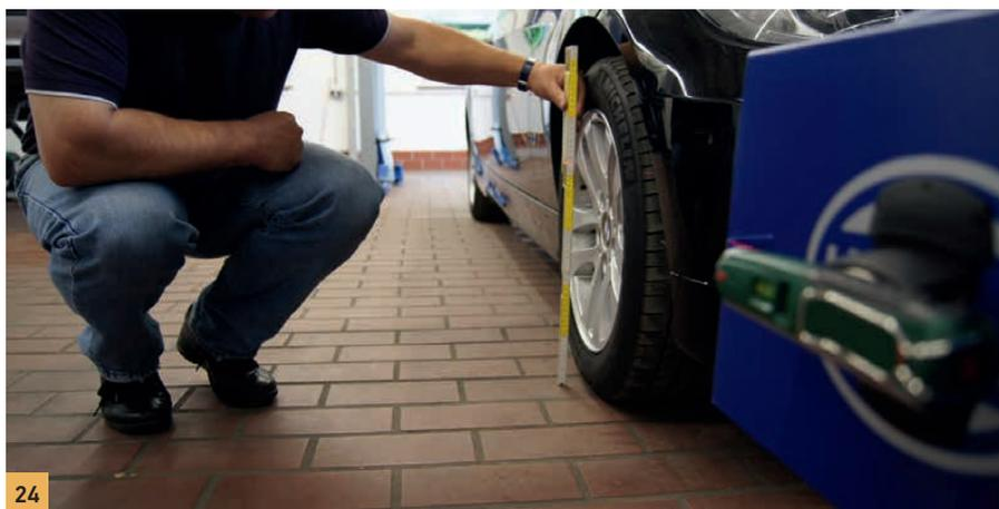
13. Si ambos valores difieren entre sí, deberá conseguirse el mismo valor en ambos ejes por medio de un ajuste del eje excéntrico. Ya se han conseguido 42 cm, ver imagen 25.
