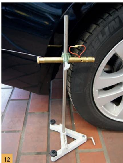
2. El trípode se sitúa tras la rueda trasera, muy cerca de ella, y en paralelo a la carrocería, ver imagen 13. La altura de montaje del láser quedará determinada por la posición de la caja óptica. Aunque deberá ser lo más baja posible.
