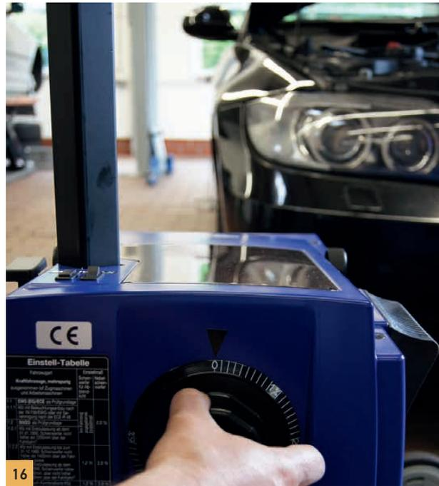
7. Dependiendo de la inclinación de la superficie de apoyo se verá el punto láser por encima o por debajo de la línea discontinua del límite clarooscuro. Por medio del eje excéntrico (ver imagen 17) deberá modificarse la inclinación de la caja óptica de modo que el punto láser se sitúe justo sobre el límite clarooscuro, ver imagen 18.
