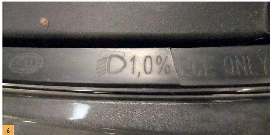
Por ejemplo, 1 % significa que la luz de cruce se inclina 10 cm en un alcance de 10 m. Mediante la rueda graduada, la pantalla de comprobación se ajusta siguiendo el porcentaje indicado, ver imagen 7.
