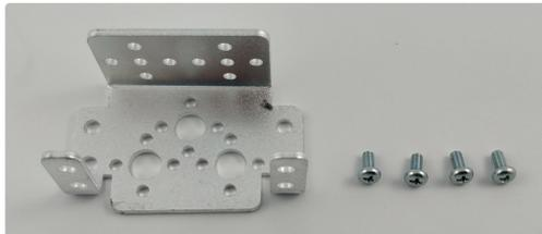
Sujetamos el soporte del servo con los cuatro tornillos, en la posición que se muestra en la siguiente foto.
