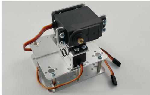
Usando el plato de plástico en forma de estrella, que viene con el servo, giramos el eje del servo en sentido horario hasta que haga tope. Ten cuidado y mueve el eje despacio. Una vez que lleguemos al tope retiramos el plato de plástico.
