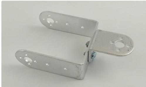
Sujetamos el conjunto anterior al soporte del servo con cuatro tornillos de M3 x 6 y cuatro tuercas de M3.
