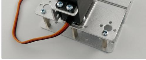
Usando el plato de plástico en forma de estrella, que viene con el servo, giramos el eje del servo en sentido horario hasta que haga tope. Ten cuidado y mueve el eje despacio. Una vez que lleguemos al tope retiramos el plato de plástico.
