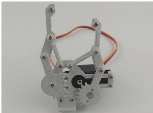
Colocamos el plato sobre el eje metálico del servo, presionamos y lo sujetamos con un tornillo, tal y como se muestra en la siguiente imagen.
