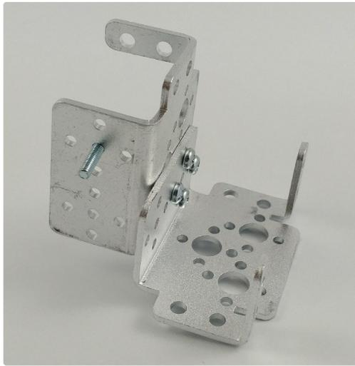
Sujetamos el servo con los cuatro tornillos de M3 x 6 y las cuatro tuercas de M3.
