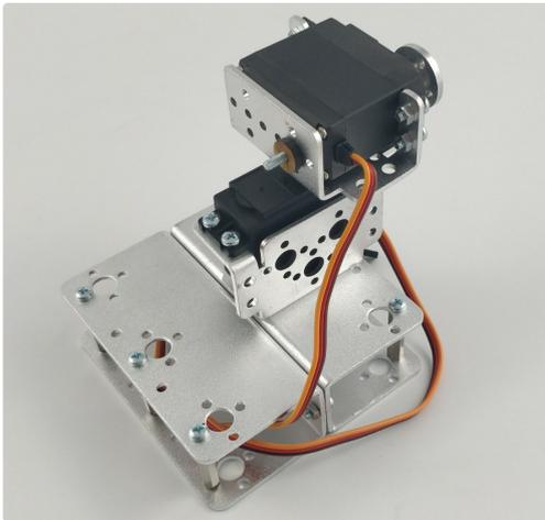
Sujetamos los herrajes al plato del servo con cuatro tornillos de M3 x 6 mm.
