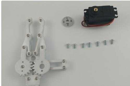
Usando el plato de plástico en forma de estrella, que viene con el servo, giramos el eje del servo en sentido horario hasta que haga tope. Ten cuidado y mueve el eje despacio. Una vez que llegemos al tope retiramos el plato de plástico.
