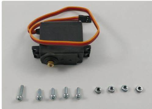
Colocamos el tornillo de M3 x 12 en el agujero del soporte del servo que se muestra en la siguiente imagen.
