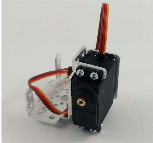
Usando el plato de plástico en forma de estrella, que viene con el servo, giramos el eje del servo en sentido anti-horario hasta que haga tope. Ten cuidado y mueve el eje despacio. Una vez que lleguemos al tope retiramos el plato de plástico.
