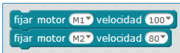
Fig1. Control de motores del mBot
