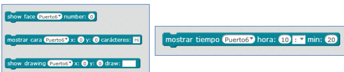
Fig 3: Comandos para la Matriz de LEDs y para mostrar el tiempo
