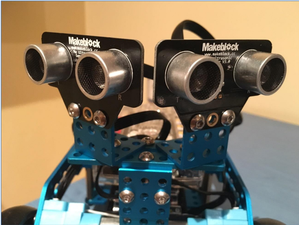
mBot Ranger con 2 sensores de ultrasonidos.
