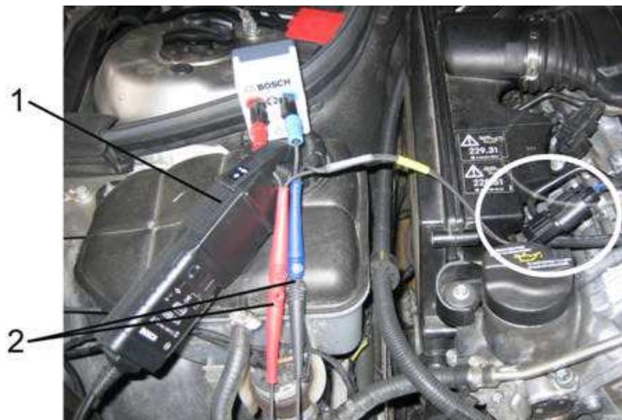
1 = Medición de corriente (pinzas de corriente)
