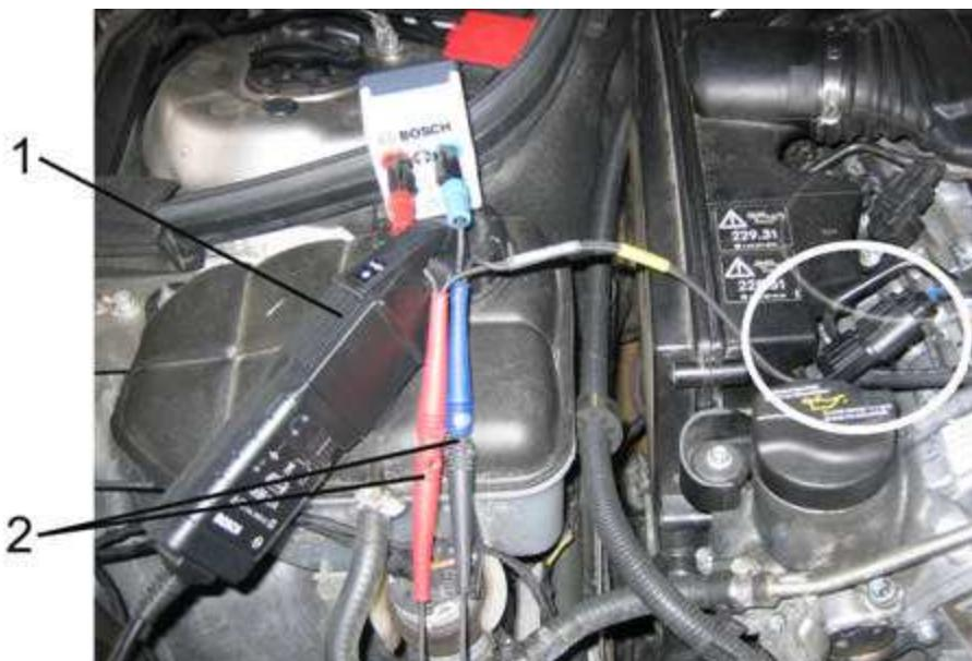
1 = Strommessung (Stromzange)
