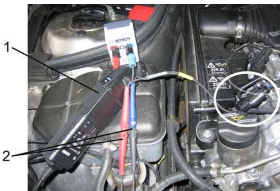
1 = Misurazione della corrente (pinza amperometrica)
