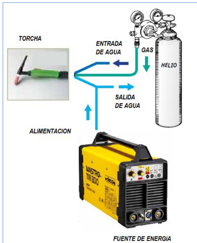
Fig.8: Instalación de soldeo TIG, con porta electrodos refrigerado con agua y con unidad de alta frecuencia.
