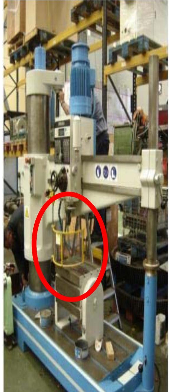
Un cabezal dispuesto en la parte superior de la columna soporta el motor de accionamiento, que por medio de un reductor de velocidades hace girar al husillo portabrocas. La broca se fija en el husillo mediante el dispositivo centrador de pinzas
