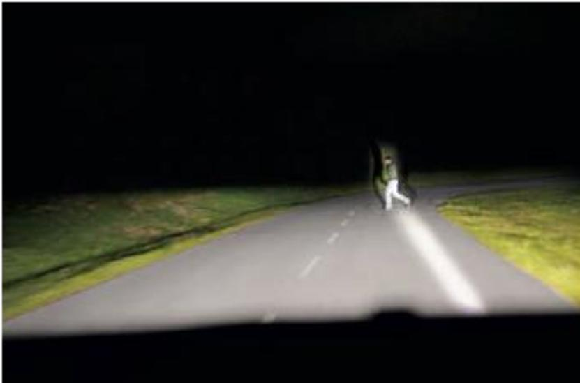
Ésta función puede mantener un objeto iluminado a 67 metros en la parte frontal del vehículo de forma dinámica.
