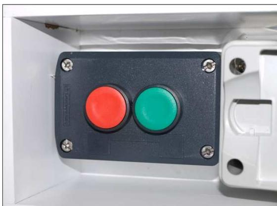
El proceso de carga puede ser detenido en cualquier momento mediante la pulsación del botón rojo ubicado en el panel de control. Esta operación detiene el proceso de carga, pudiendo ser reiniciado en cualquier momento mediante la pulsación del botón verde. Adicionalmente, en esta posición se encuentran ubicados los
