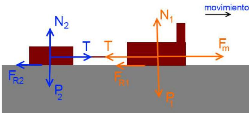
Es evidente que, siendo las masas de la locomotora y del vagón diferentes, las fuerzas peso, normal y de rozamiento son diferentes entre sí. Sin embargo, las dos tensiones son iguales. La tensión en la locomotora se opone al movimiento, mientras que la tensión en el vagón es responsable de su movimiento.
