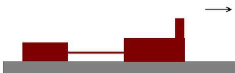
Veamos otro ejemplo en el que interviene la tensión como fuerza. Supongamos un tren formado por una cabeza tractora y un vagón que se mueve horizontalmente sobre una vía. Vamos a plantear las fuerzas que se ejercen sobre el vagón y sobre la locomotora.
