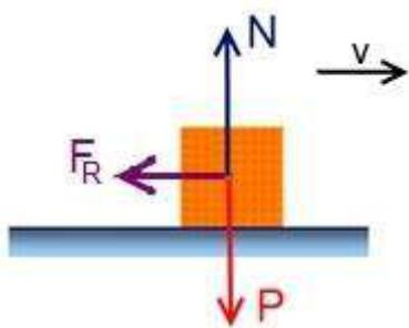
En la figura adjunta el vector velocidad indica el sentido del movimiento y se representan las tres fuerzas que actúan sobre la caja:
