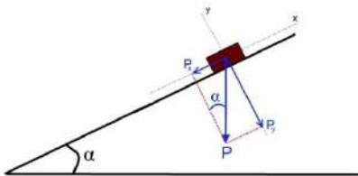
Identificamos el ángulo del plano en el paralelogramo (es el ángulo que contiene a los lados del paralelogramo que son perpendiculares a los lados del plano inclinado).
