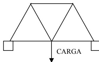
O cimbro dunha ponte ferroviaria presenta a estrutura reticular representada na figura. O cimbro apoia cada un dos seus extremos sobre un pilar de formigón armado cunha resistencia á compresión de  $8 \text{ N/cm}^2$ . A ponte deseñouse para soportar unha carga máxima de 200 Tn.
