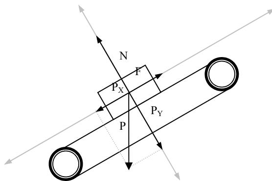
O esquema representado na figura corresponde a unha cinta transportadora empregada para subir mercadorías por unha pendente que forma  $30^\circ$  coa horizontal. A potencia útil do sistema é de 20 W, e é capaz de transportar unha mercadoría de peso P a unha velocidade constante de 0'2 m/s.
