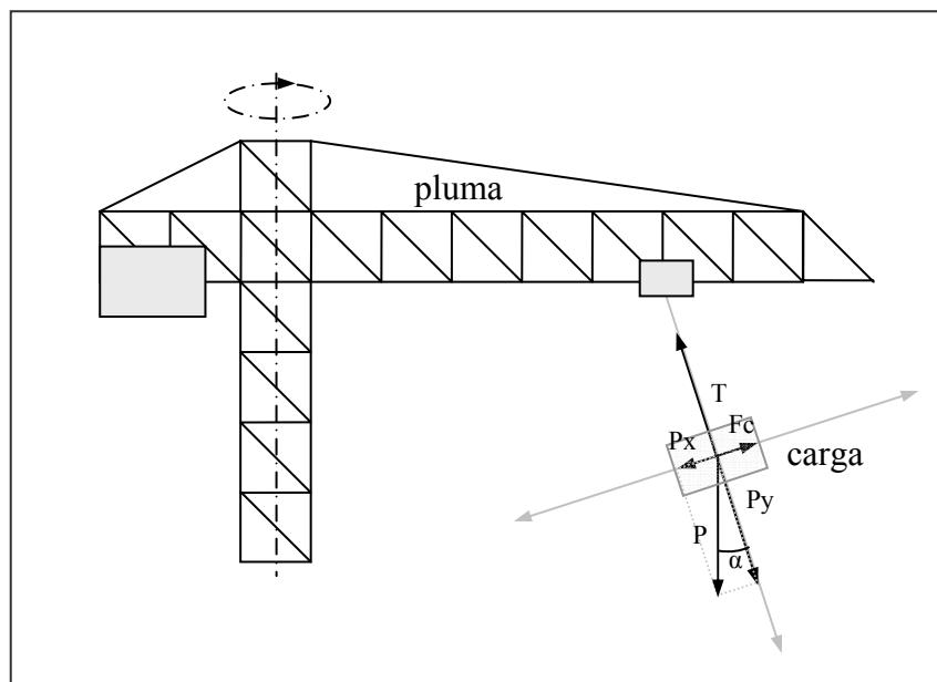
O guindastre representado na figura pode levantar unha carga máxima de 45.000 N.
