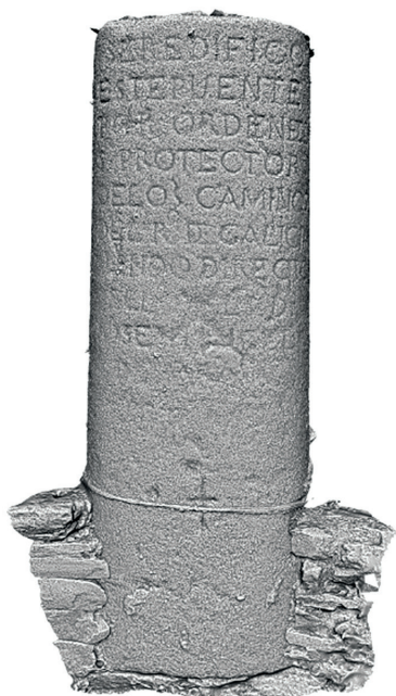
2. Miliario fotogrametría. A técnica revela a inscrición do século XVIII. Foto Colectivo Patrimonio dos Ancares
