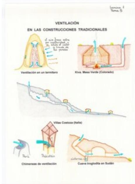
En Oriente Medio se aprovecha la tendencia a ascender del aire caliente para succionar aire a través de conductos subterráneos y de este modo refrescar las casas. Para evitar el calentamiento por soleamiento, las ventanas y algunas paredes exteriores están hechas con celosías de madera o piedra tallada para permitir la ventilación e impedir el paso de la radiación solar.
